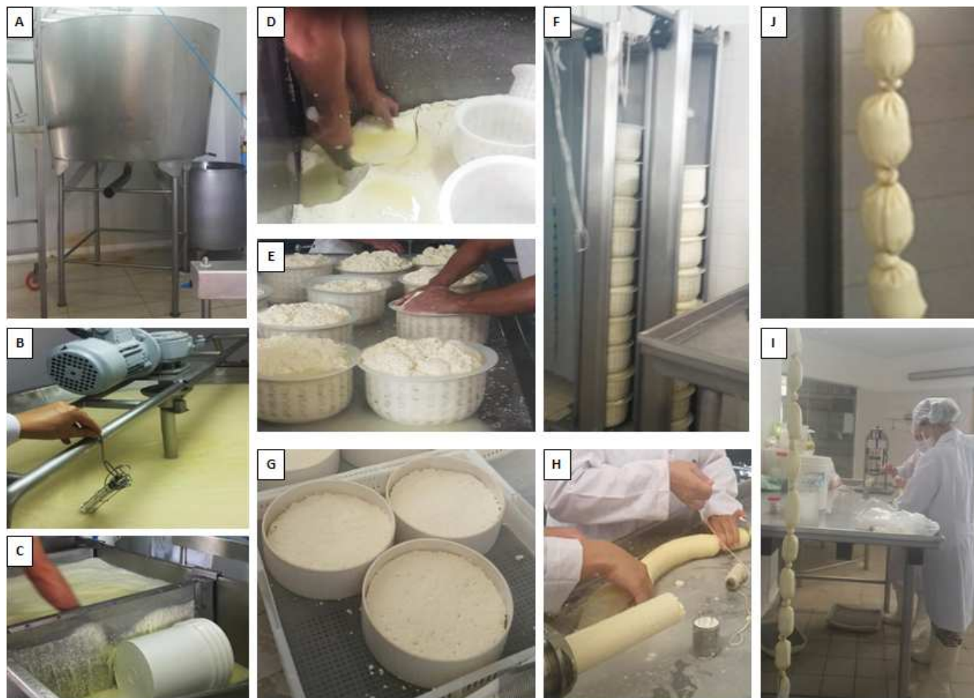
Figura 26: Elaboración de las masas lácteas en Cabaña Piedras Blancas. (A) tanque de pasteurización, (B) coagulación, (C) desuerado, (D y E) moldeado de pasta semidura (SP), (F) prensado de masa de pasta semidura, (G) masa de pasta blanda (PB) moldeada, en reposo, (H e I) embutido y atado, (J) oreo.
