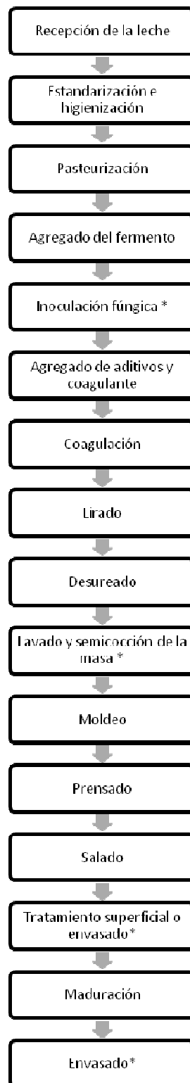
Figura 1: Diagrama de bloques del proceso de elaboración de queso.
