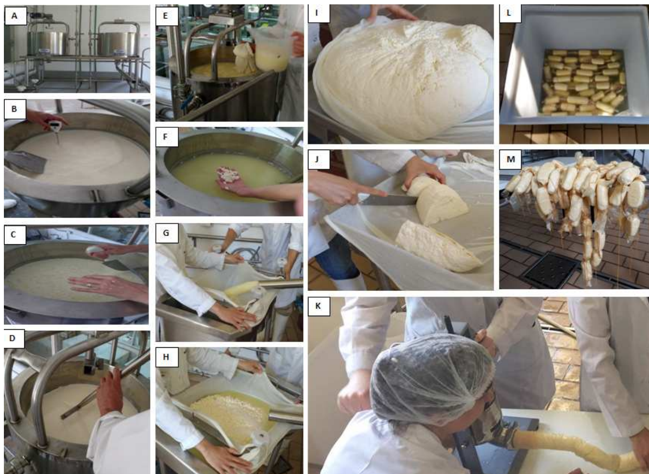
Figura 27: Elaboración de masa de queso Tybo en en la Planta Piloto de INTI Lácteos. (A) tinas de pasteurización, (B) coagulación, (C) corte de cuajada, (D) lirado, (E) lavado y cocción de la masa, (F) grano obtenido tras la cocción (G y H) filtrado y (I y J) masa prensada, (K) embutido, (L) salado en salmuera y (M) oreado.
