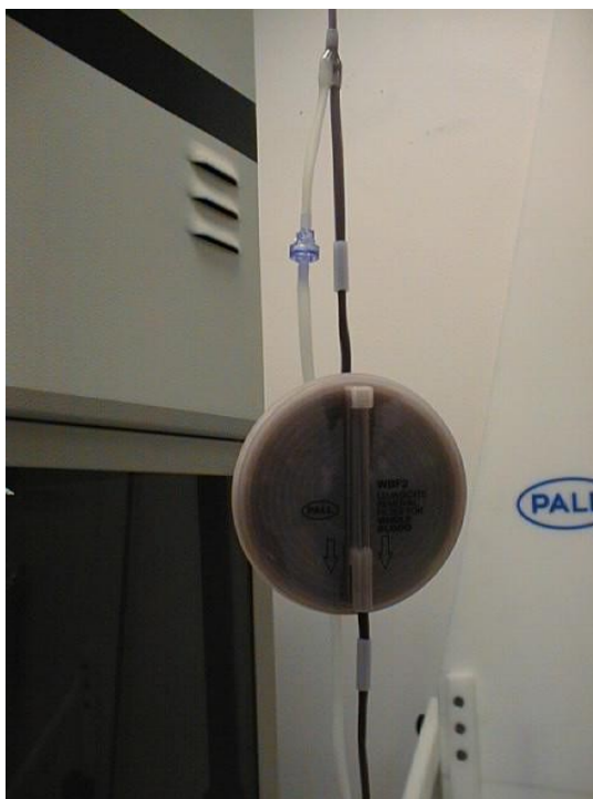
Fig. 31 Filtro leucorreductor para sangre entera durante la filtración.
