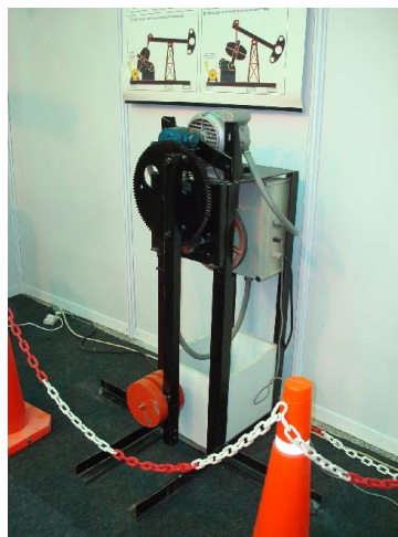
Asistente eléctrico de arranque por balanceo de AIB
