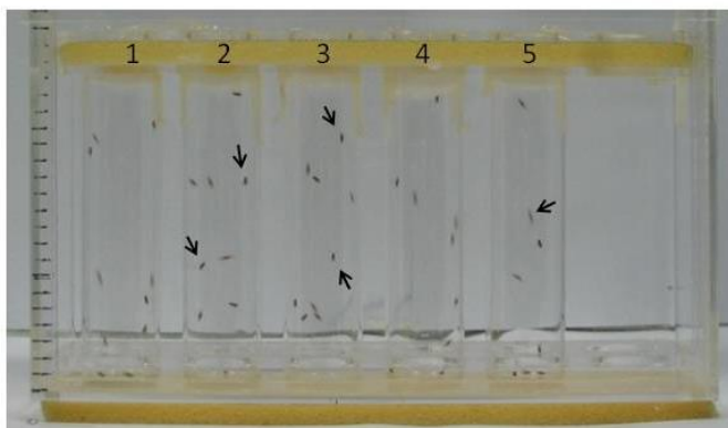
Figura 15. Dispositivo RING. El aparato permite colocar 6 viales de vidrio (aquí se muestran solo 5), los cuales contienen a las 10 moscas. Las flechas indican las moscas dentro de cada vial.
