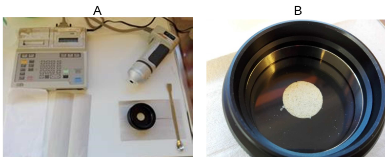
Figura 6: En la Figura A (izquierda) se observa el Colorímetro Minolta CR-300 utilizado para la determinación de color y en la Figura B (derecha) se observa el accesorio CR-450 para materiales granulares
