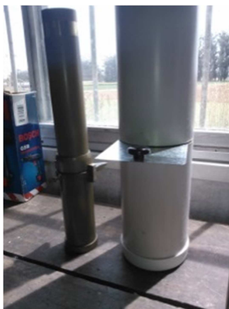
Figura 8: Instrumento de medición diseñado para medir la densidad volumétrica del expeller de soja donde se aprecia la comparación entre la balanza de Schopper y el instrumento diseñado
