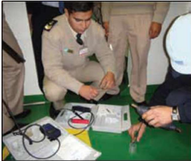
Figura 20: Control de salinidad del agua de lastre por parte del personal de la Prefectura Naval Argentina.
