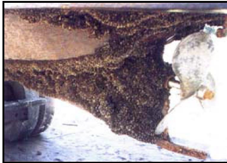
Figura 14: Macrofouling ocasionados por Limnoperna fortunei , en el casco de una lancha pesquera deportiva (imagen gentileza de Maria Cristian Mansur).
