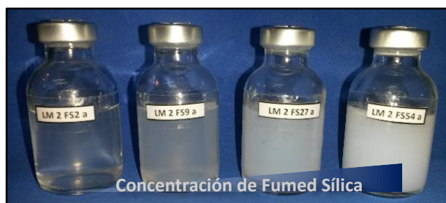
Figura 2.21 Estado de las muestras previo a la irradiación De izquierda a derecha: FS2; FS9; FS27 y FS54
