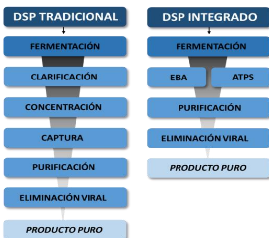
Figura 1.6 Comparación entre un proceso de DSP tradicional y uno con integración de procesos
