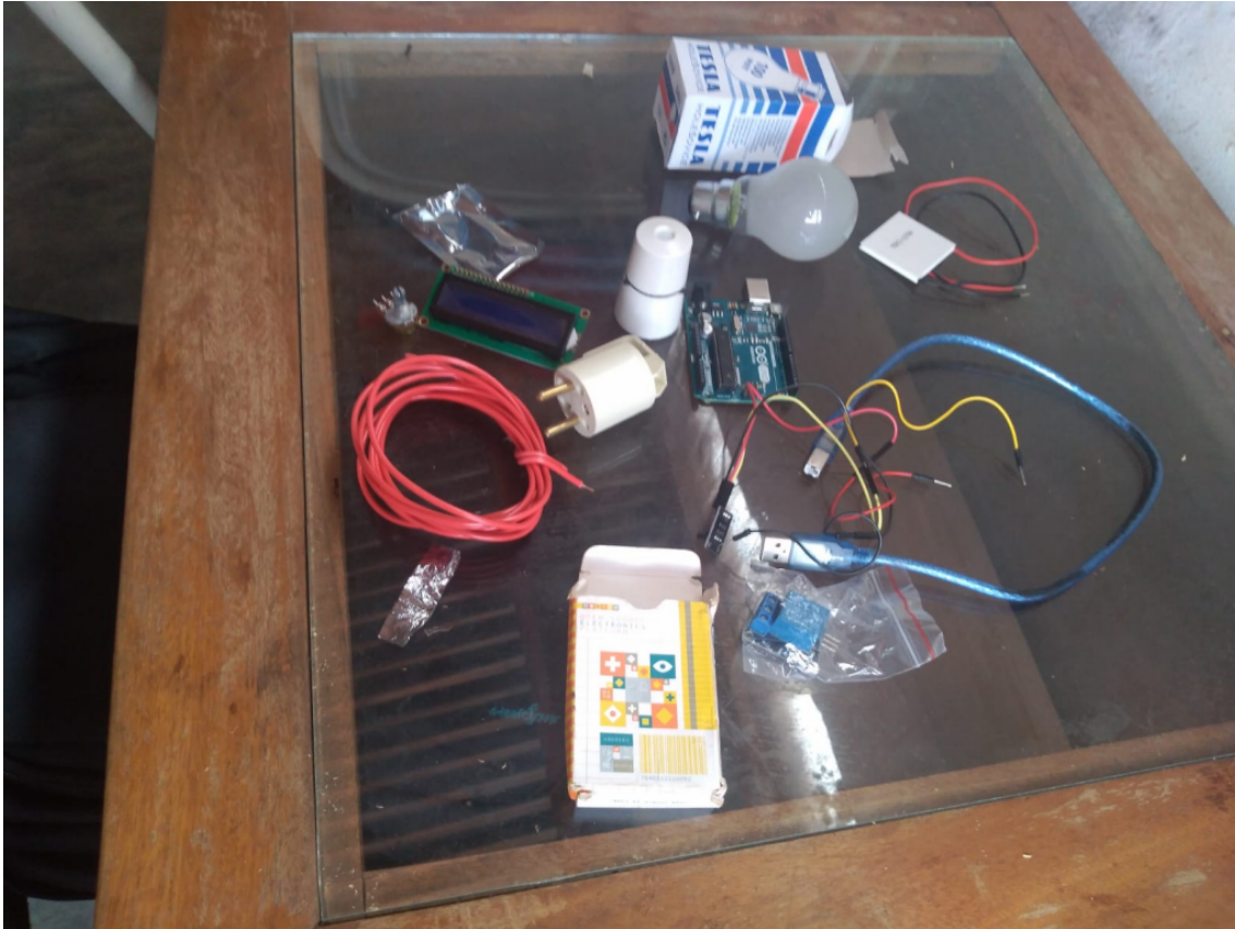
Figura 7.15: KossamTor: electrónica necesaria para construir la incubadora
