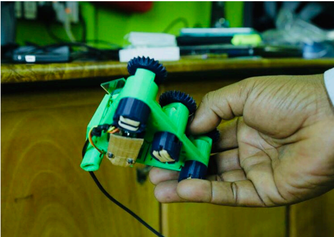
Figura 7.4: Open Flexure: primeros microscopios, o sayansiscopes fabricados en Tanzania (fuente: Twitter BuniHUB)
