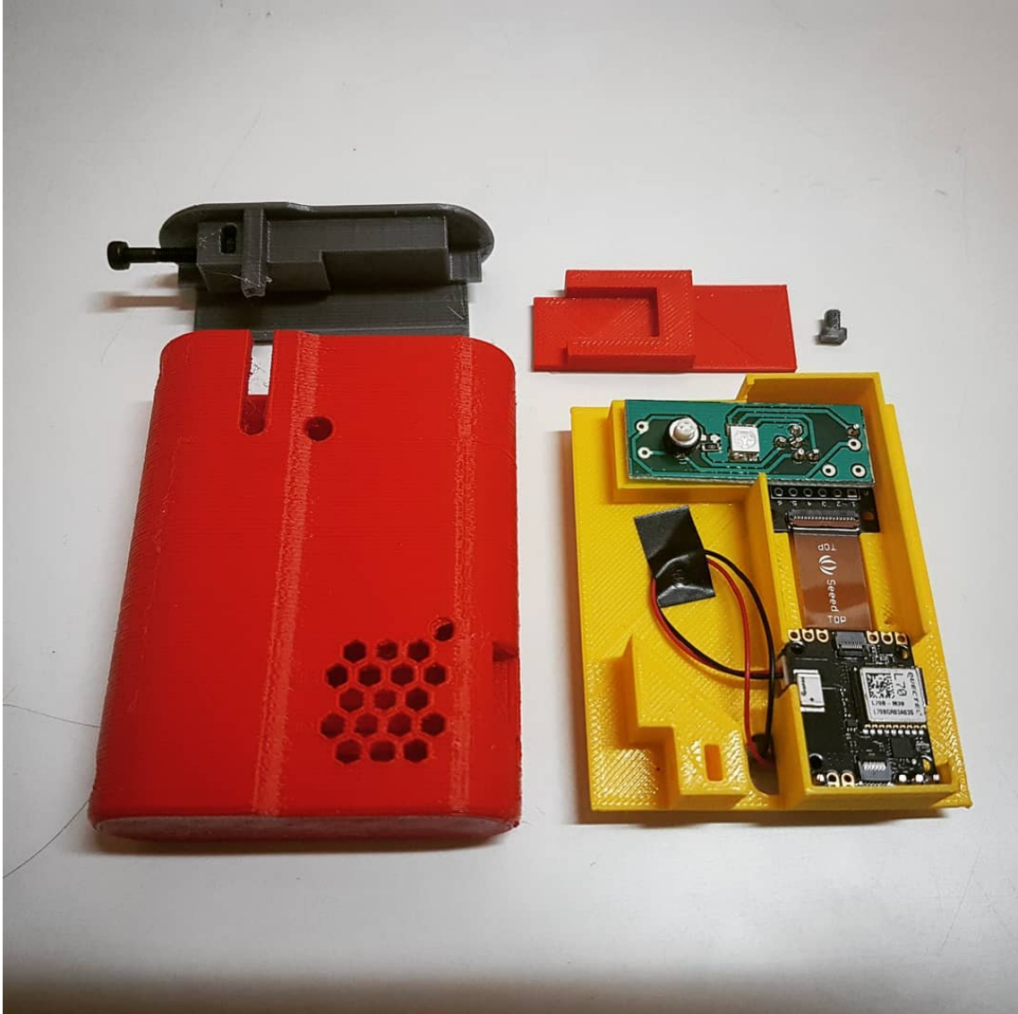
Figura 7.2: Gorgas tracker: vista del interior del dispositivo (fuente: proyecto Gorgas Tracker)
