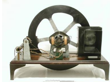
Fig. 1, televisor mecanico con disco de Nipkow, obtenido de https://commons.wikimedia.org/wiki/File:Televisore_meccanico,_a_disco_di_Nipkow_-_Museo_scienza_tecnologia_Milano_02201_01.jpg
