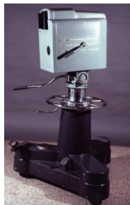
Fig. 5, telecamara con tubo iconoscopio utilizado para televisión electronica, obtenido de https://commons.wikimedia.org/wiki/File:Telecamera_per_ripresa_televisiva_elettronica_a_valvole_bianco_e_nero_con_tubo_iconoscopio_-_Museo_scienza_tecnologia_Milano_02240.jpg
