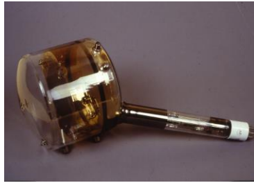
Fig. 6, Iconoscopio, obtenido de https://commons.wikimedia.org/wiki/File:Tubo_da_ripresa televisiva di Zworykin - Museo scienza tecnologia Milano 02202.jpg
