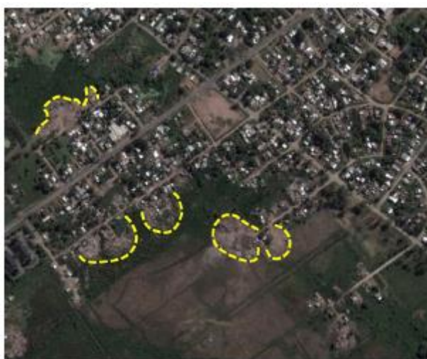
Ilustración 31-Rellenos precarios en zona de bañados
