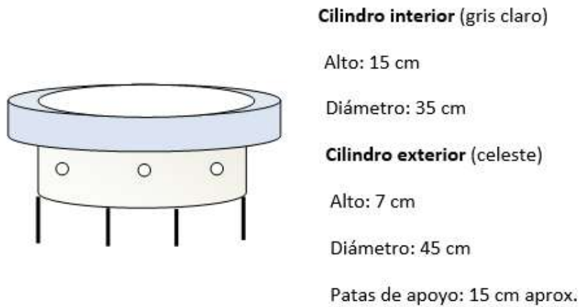
Esquema 1: base de hierro para asentar la cámara estática
