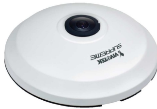
(a) Cámara fisheye VIVO-TEK modelo FE8172.
