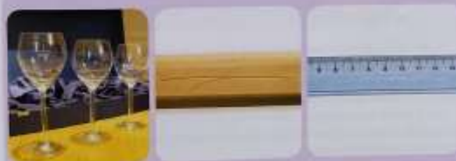
El vidrio es más duro que la madera y que el material plástico de la regla.
