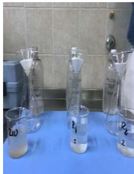
Figura 8: Filtrado 1 250 ml de muestra homogeneizados se los filtró utilizando un filtro de 28 \mu\text{m} de tamaño de poro para quitar interferencias de la muestra.
