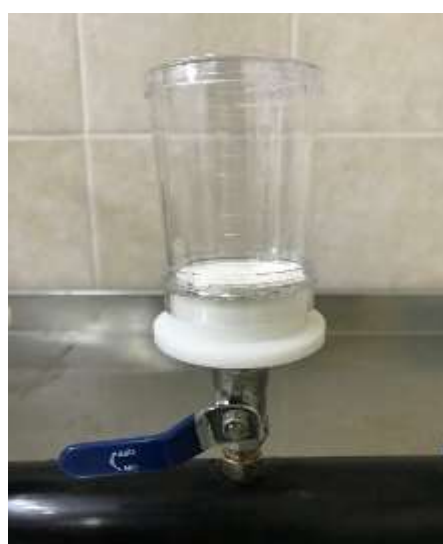
Figura 9: Equipo de Filtración por Membrana (manifold) y monitores de membranas con poros de 0,45 \mu\text{m} .
