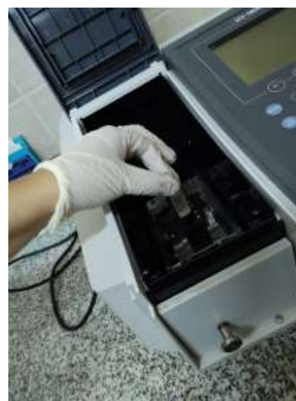
Figura 14: Acidificación de la muestra y posterior lectura espectrofotométrica.
