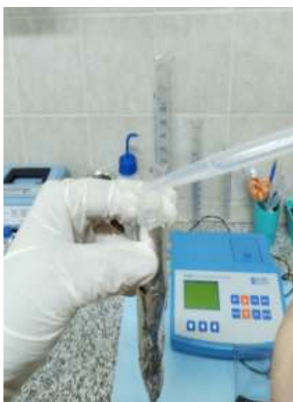
Figura 14: Acidificación de la muestra y posterior lectura espectrofotométrica.
