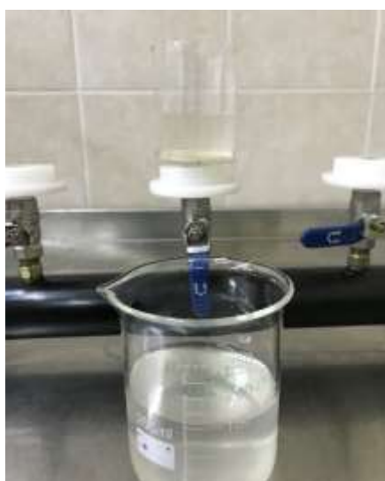
Figura 10: Filtración 2: filtración con filtros de fibra de vidrio GF/C (0,47 \mu\text{m} ).
