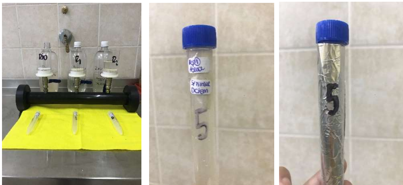
Figura 11: Preparación de las muestras para lectura espectrofotométrica antes de se realice la acidificación.
