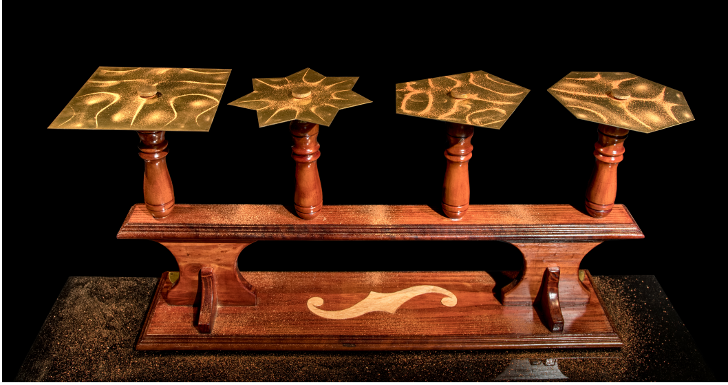
Figura 4.4: Figuras de Chladni sobre placas metálicas. Fuente: Matemateca (IME/USP)/Rodrigo Tetsuo Argenton. Con licencia CC-BY-SA 4.0
