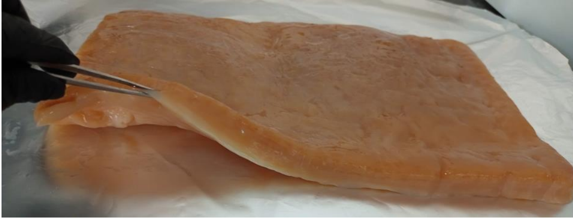
Figura 3.2. Película flotante desarrollada en la interfaz aire-líquido durante la producción de té de Kombucha recuperada luego de 14 días de cultivo.
