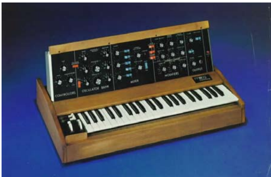
FOTO 3. EL MINIMOOG CONSTRUIDO CON PLAQUETAS DE CONEXIÓN, SIN CABLES A LA VISTA. ERA PORTÁTIL Y PERMITIÓ REALIZAR PRESENTACIONES EN VIVO.
