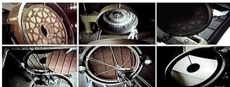
Ilustración 15. Proceso de aluminizado del espejo utilizando la campana de alto vacío. Fotos de Cristian Willemöes
