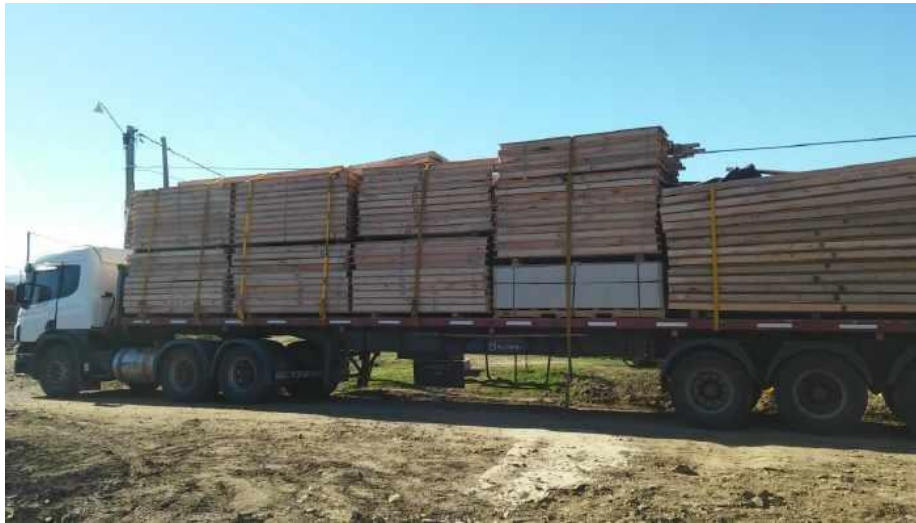
Imagen 12. Envío de kit para 4 viviendas en camión semirremolque de 14m
