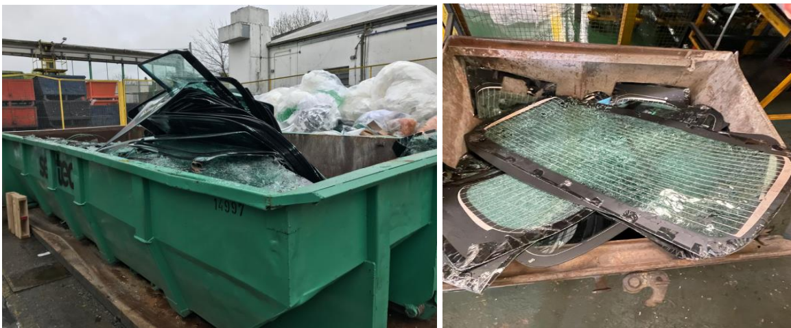
Fig. 13: Volquetes con placas de vidrio laminado defectuosas o rechazadas (izquierda) y vidrios templados defectuosos o rechazados (derecha) presentes en PAASA.
