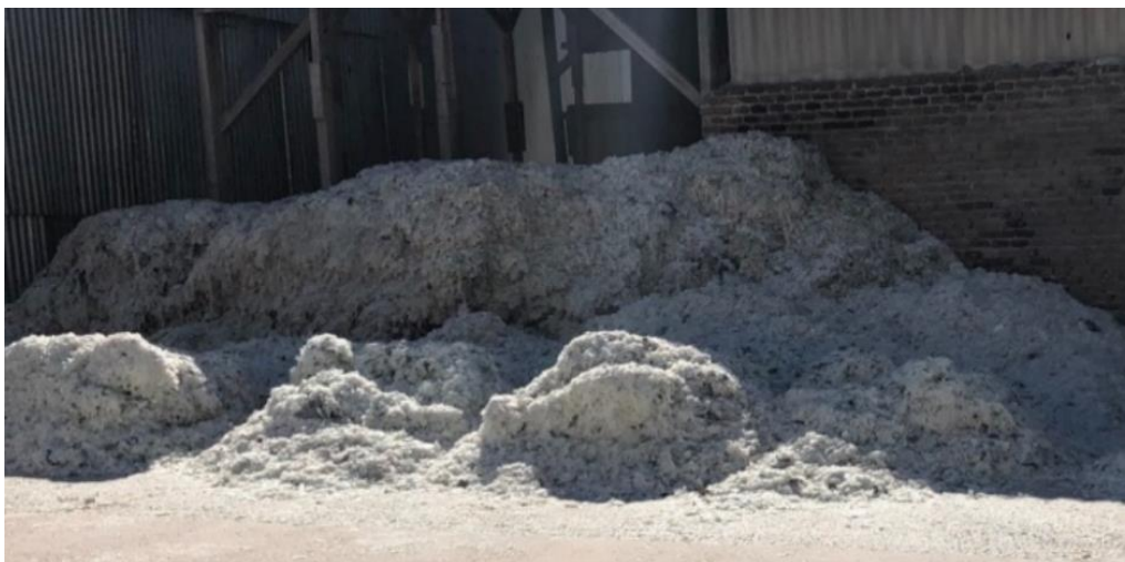
Fig. 15: Rezagos de PVB acumulado luego de proceso de molienda y separación, previo a envío a rellenos sanitarios para enterramiento. Fuente: Elaboración propia.
