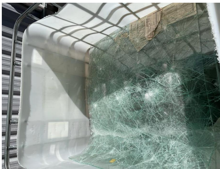
Fig. 8: Residuos de placas de vidrio de seguridad, con lámina de polivinil intermedia. Fuente: Elaboración propia.
