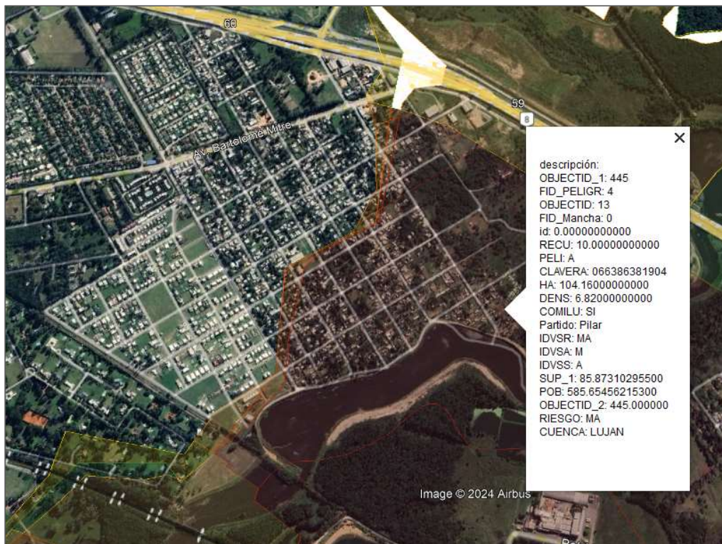
Figura 13. Resultado de la valoración de riesgo para el barrio río Luján. Las líneas delimitan polígonos por nivel de riesgo. El área con mayor opacidad señalada corresponde al nivel de riesgo “MA” (Muy Alto). Fuente: ComiLu (2024).
