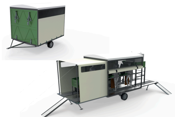
Figura 22. Propuesta que al igual que la unidad productiva A parte del Big Bag y el volcado sobre una tolva para recibir las cebollas (Propuesta de Sofía Marozzi, Tableros, 2017).
