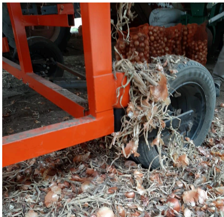
Figura 36. En la imagen se observa cómo se depositan los residuos del descolado y luego generan inconvenientes al momento de movilizar la PCAC hacia otro Big Bag (Estación de Poscosecha de cebolla a Campo Informe Ensayo INTA, 2021).
