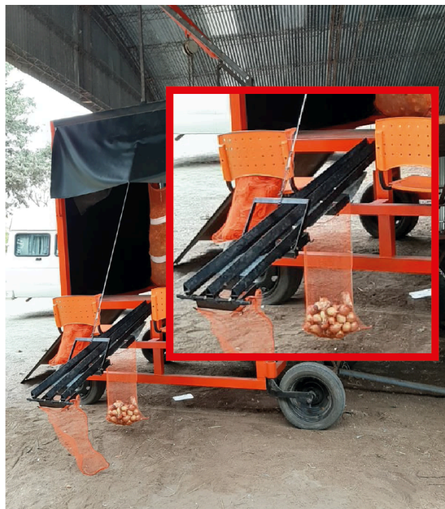
Figura 34. En esta imagen se observa la situación de uso del brazo calibrador, como se sujetan las bolsas y como se sostiene tensado a la estructura central. Fuente: Registro fotográfico construcción del prototipo funcional (2021) INTA EE Hilario Ascasubi.
