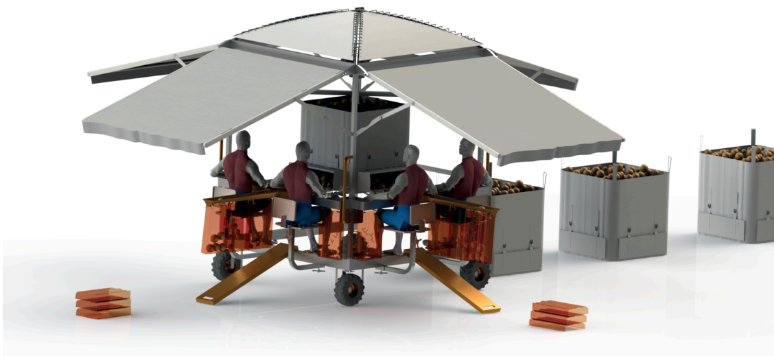
Figura 24. En esta imagen se presenta la propuesta seleccionada en situación de trabajo se observa el avance sobre el Big Bag y como se disponen las bolsas calibradas. Fuente: Presentación institucional IPAF Región Pampeana. Propuesta de Haag (2019).
