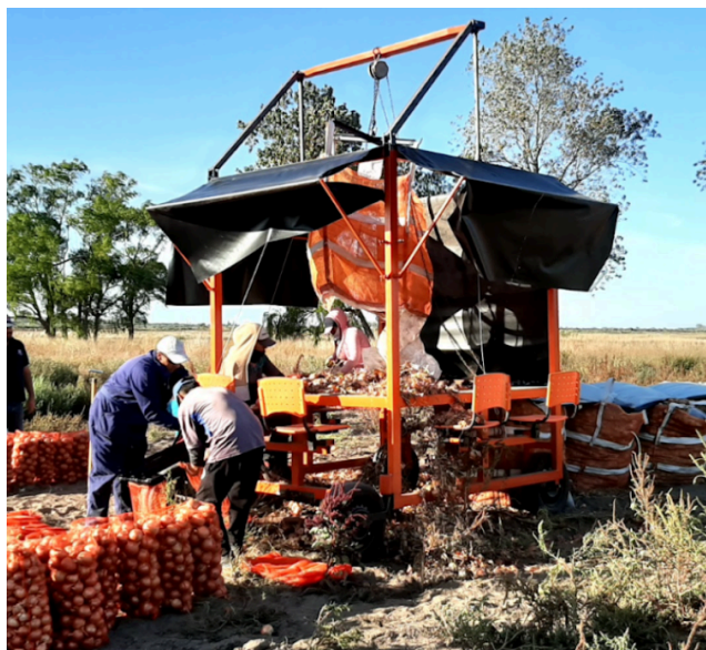
Figura 37. En esta imagen se ilustra la situación de uso de la PCAC. El avance sobre el big bag y como se ordena el producto empaquetado en los laterales (Estación de Poscosecha de cebolla a Campo Informe Ensayo 1° INTA, 2021).
