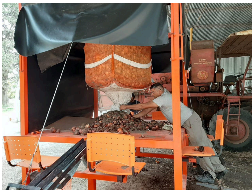
Figura 31. En esta imagen se observa cómo se desplazan las cebollas sobre la mesa contenedora cuando se realiza la apertura inferior del Big Bag.
