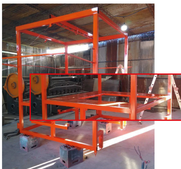
Figura 32. Detalle del rediseño y simplificación de la mesa de trabajo. Fuente: Registro fotográfico construcción del prototipo funcional (2021) INTA EE Hilario Ascasubi.
