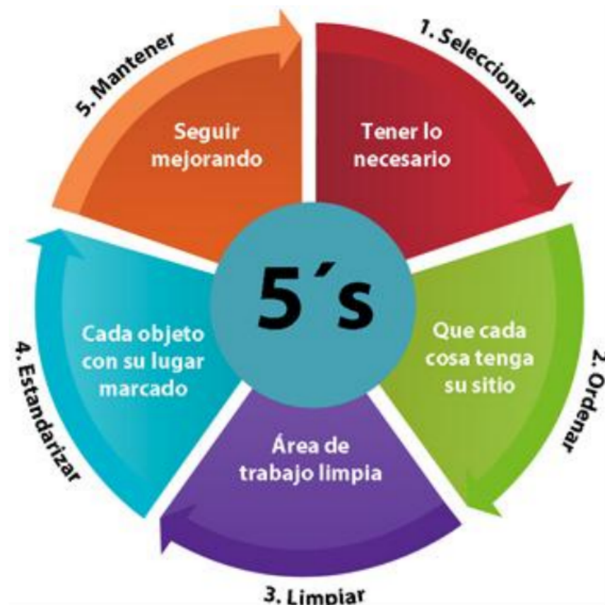
Figura 38. Esquema de las 5S. Fuente: https://911e.com.ar/tecnica-de-gestion-japonesa/
