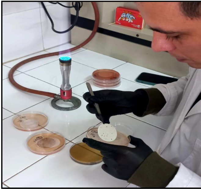
Foto 9: Transferencia de membrana con colonias hacia las placas conteniendo el medio de cultivo BEA . Fuente: Propia.
