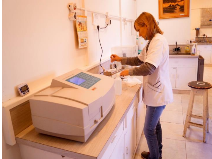
Figura N° 6 Espectrofotómetro de laboratorio que se utiliza para medir la cantidad de Licopeno en tomate Fuente: Fotografía propia
