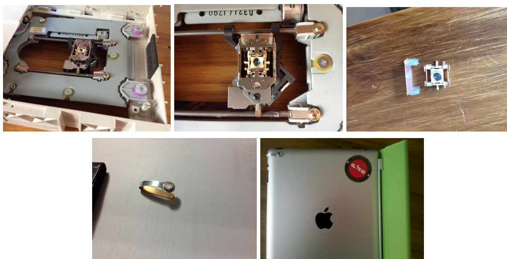
Secuencia de un desarmado de una lectora CD ROM y creación de un Microscopio DIY para celular Fuente: MATESLAB
