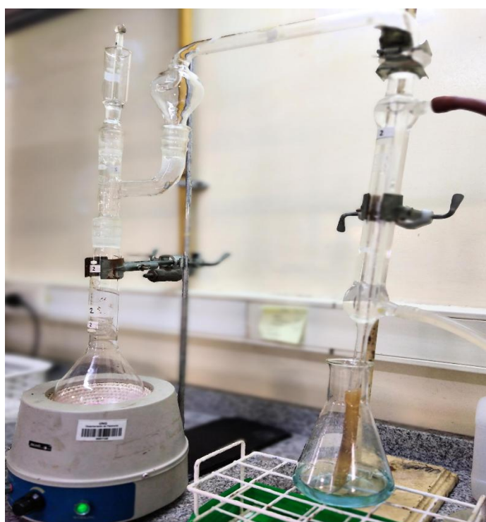
Figura 4.7.3. Equipo de destilación para determinación de nitrógeno básico volátil (NBV).
