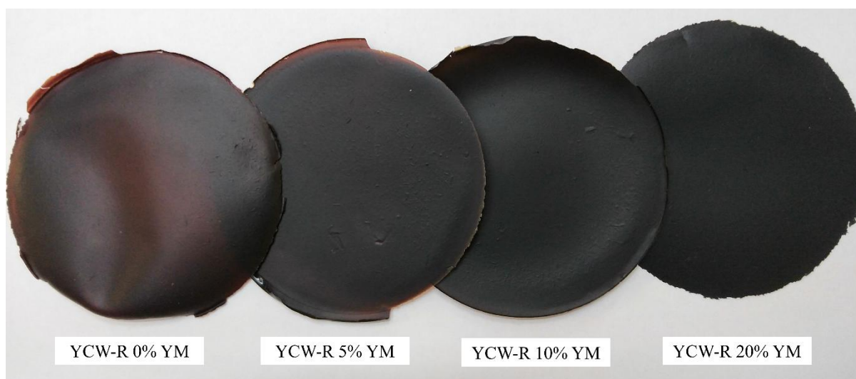
Figura 5.6.1. Películas de pared celular de levadura residual cervecera con diferentes concentraciones de extracto de yerba mate residual.
