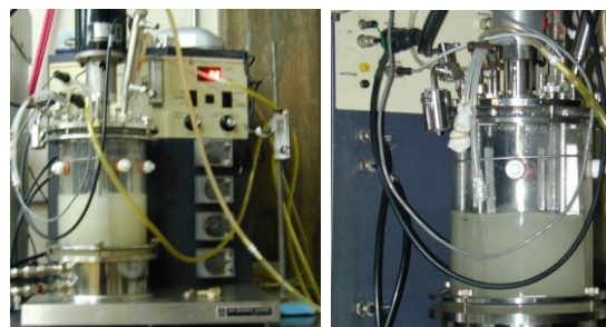
Figura 5.7 Fermentador New Brunswick Bioflo III de 5 L de capacidad
