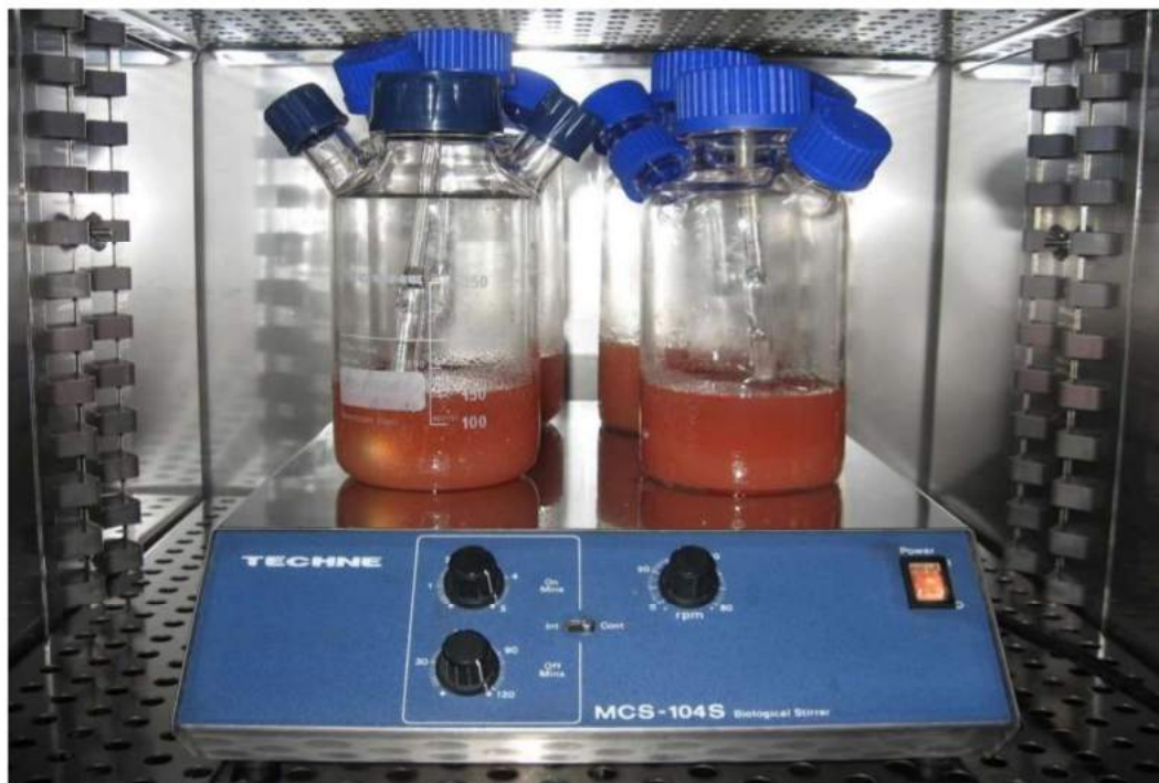
Figura 50: Frascos de cultivo, adentro de la estufa con plataforma giratoria.
